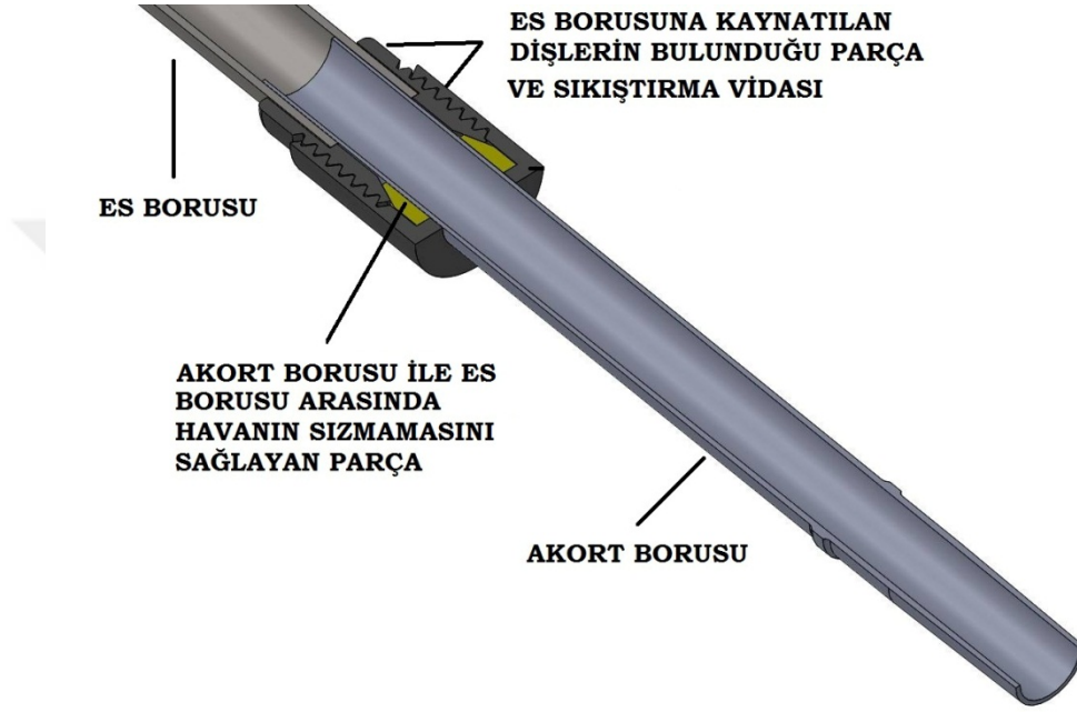
Resim 11. Yeni Sistem Es Borusu Parçaları
