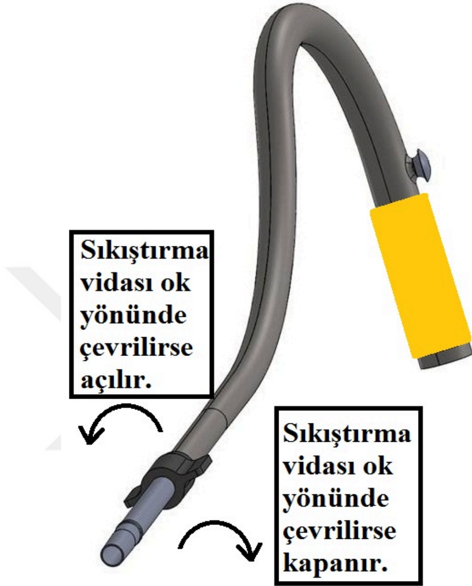
Resim 12. Yeni Sistem Es Borusu Sıkıştırma Vidasının Kullanımı
