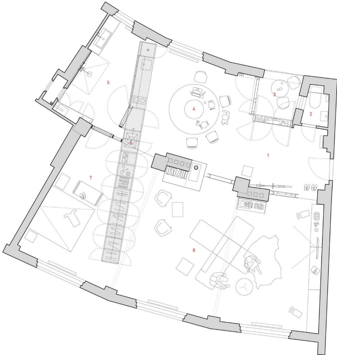
Pôdorys bytu návrh / Plan proposal 1-hala / entrance hall, 2-toilet, 3-loggia, 4-kuchyňa+jedáleň / kitchen+dining room, 5-kúpeľňa / bathroom, 6-práčovňa / laundry, 7-spálňa / bedroom, 8-obyvacia izba / living space
